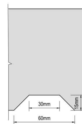
03 VERTICAL DUMMY JOINT DETAIL
