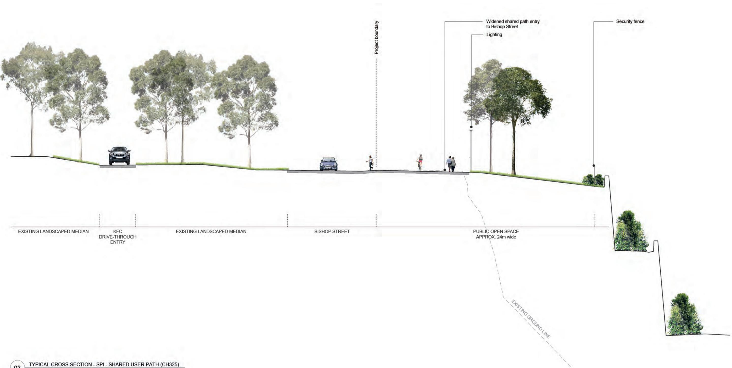
03 TYPICAL CROSS SECTION - SPI - SHARED USER PATH (CH325)
