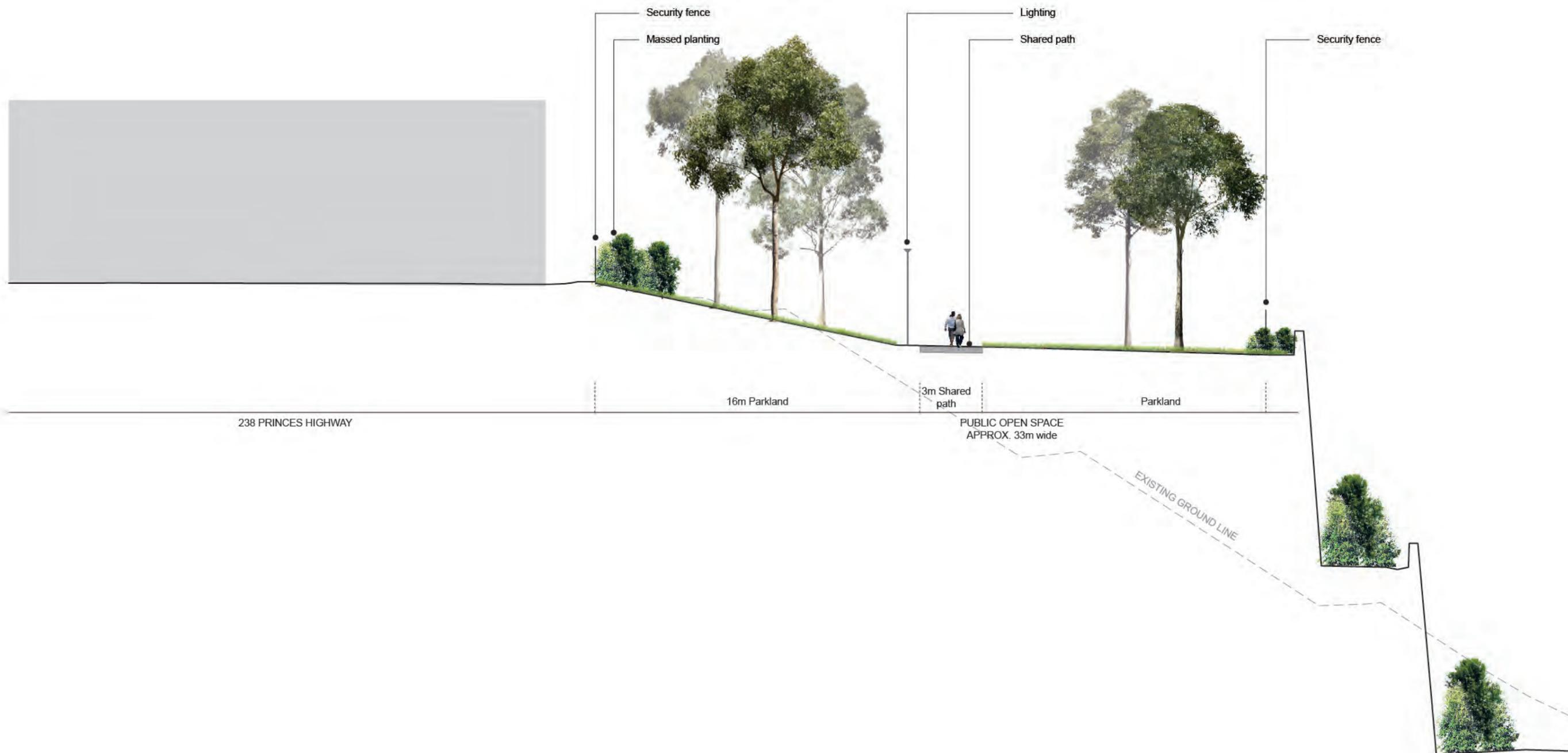
02 TYPICAL CROSS SECTION - SPI - SHARED USER PATH (CH275)
